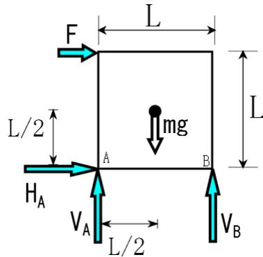
自由物体図は上図のようになり、x 方向、y 方向、A 点周りのモーメントのつり合いの式は次のようになる。
