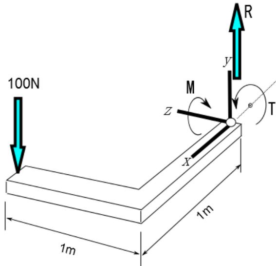
自由物体図は上図のようになり， $y$  方向の力のつり合い式， $x$  軸周りのモーメントのつり合いの式， $z$  軸周りのモーメントのつり合いの式は次のようになる。
