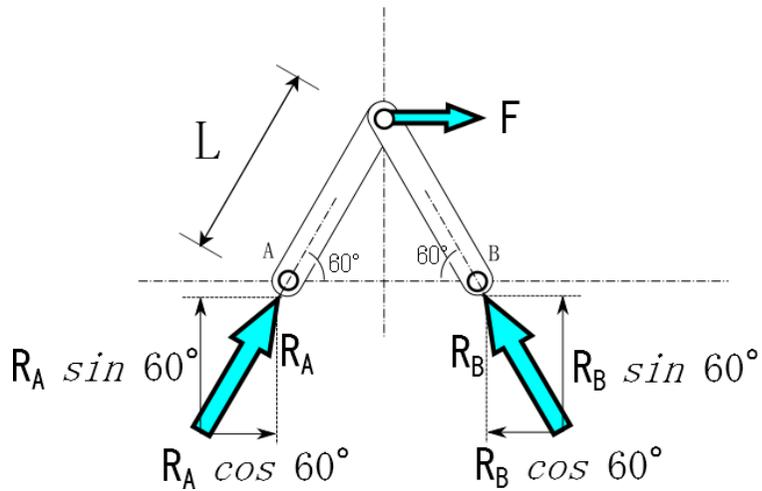
自由物体図は上図のようになり、x 方向、y 方向 A 点周りのモーメントのつり合いの式は次のようになる。
