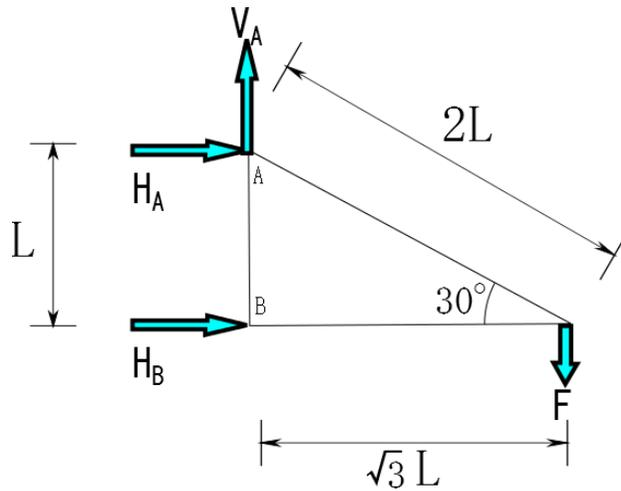
自由物体図は上図のようになり、x 方向、y 方向、B 点周りのモーメントのつり合いの式は次のようになる。
