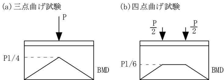
三点曲げ試験の場合、最大曲げモーメントが、荷重点のはりの中央で生じている。一方、四点曲げ試験の場合は、最大曲げモーメントは上部荷重の間で一定値となっている。6章において、はりの曲げ応力の計算を学習するが、曲げモーメントと曲げ応力には密接な関係があり、最大曲げ応力は、三点曲げ試験では荷重点で生じ、四点曲げ試験では上部荷重の間で一定値となる。したがって、試験片の最弱部が破壊の起点となる材料試験において、セラミックスのような脆性材料の場合には、三点曲げ試験では強度がばらつくことが多く、四点曲げ試験では強度のばらつきが小さくなる。
