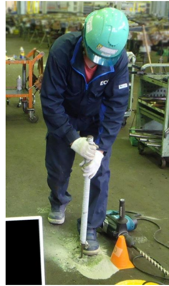
ボーリングバーで採取孔を調整 ※直径15~30 mm 程度、深さ0.8~1.0m
