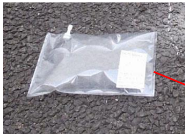
孔を密栓し、一定時間（30分以上）放置後、 捕集バッグ法により、土壌中のガスを専用 のバッグに吸引採取。
