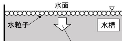
水面の低下速度  $U_{\text{水面}} = \text{水粒子の移動速度(流速)}$
