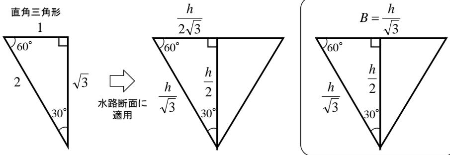
流水断面積  $A = \left(\frac{h}{\sqrt{3}} \times \frac{h}{2}\right) \times \frac{1}{2} = 0.144h^2$
