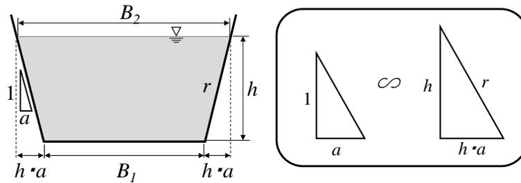
$$\text{水面幅 } B_2 : \quad B_2 = B_1 + 2h \cdot a$$
