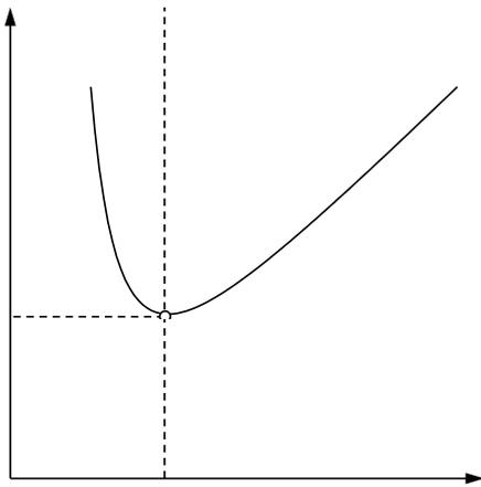
水路床が隆起する前の流れの比エネルギーを  $E_1$  とする。比エネルギーが  $E_1$  になる水深は 2 つあるが、常流の流れは  $h > h_c$  であるので、このときの水深は  $h_1$  になる。水路床が隆起すると、比エネルギーは減少して  $E_2$  の大きさになる。常流側の曲線では、比エネルギーが低下すると水深も  $h_2$  に低下するので水面は低下することになる。
