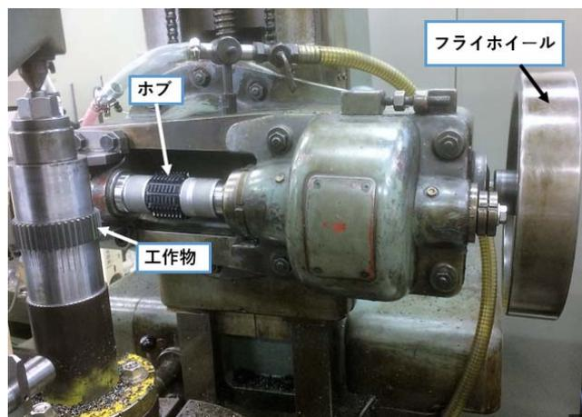
図2 ホブ盤: フライホイールの慣性モーメントにより, 切削抵抗によるホブ回転数の低下を防いでいる.
