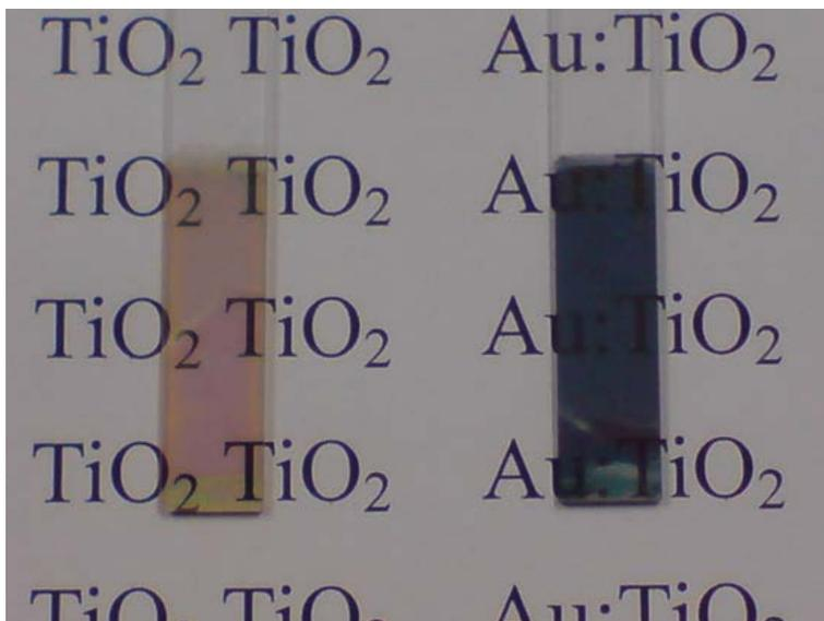
石英ガラス基板上にチタニア( $\text{TiO}_2$ , 黄色透明, 干渉により桃色)および金ナノ微粒子含有チタニア(紺色透明)をゾル-ゲル法でコートした光触媒薄膜
