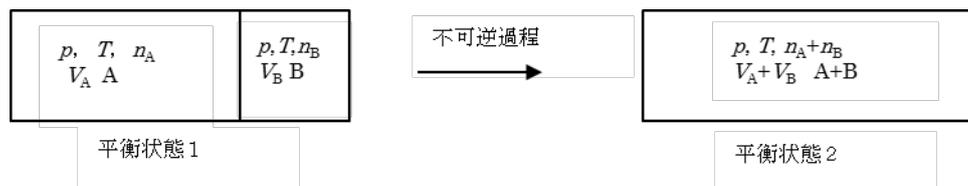
物質質量  $n_A$ [mol]の理想気体 A (圧力  $p$ [Pa], 温度  $T$ [K], 体積  $V_A$ [m<sup>3</sup>]) と物質質量  $n_B$ [mol]の理想気体 B (圧力  $p$ [Pa], 温度  $T$ [K], 体積  $V_B$ [m<sup>3</sup>]) が別々の容器中に存在し, 平衡状態 (平衡状態 1) にある。二つの容器を隔てている壁を除き, 理想気体 A と B を混合させ新たな平衡状態 (平衡状態 2) に到達させた。この状態変化 (平衡状態 1 から平衡状態 2) は不可逆過程であるため直接エントロピー変化を求めることはできない。このため同じ状態変化を与える以下の可逆過程を考える。
